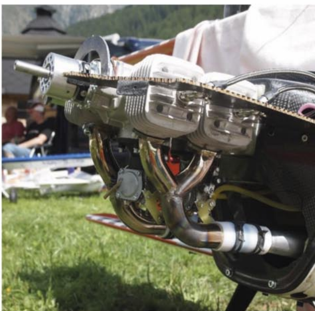
4-Zylinder 250 cm 3 Motor mit modernster Schalldämpferanlage
